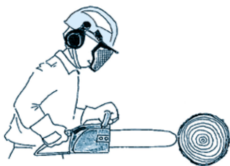
バーの先端を丸太に当てるとキックバックを 起こし先端が体の一部に当たって危険
