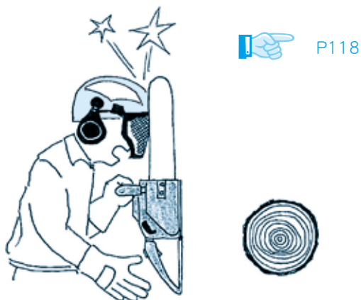
バーの先端を丸太に当てるとキックバックを 起こし先端が体の一部に当たって危険
